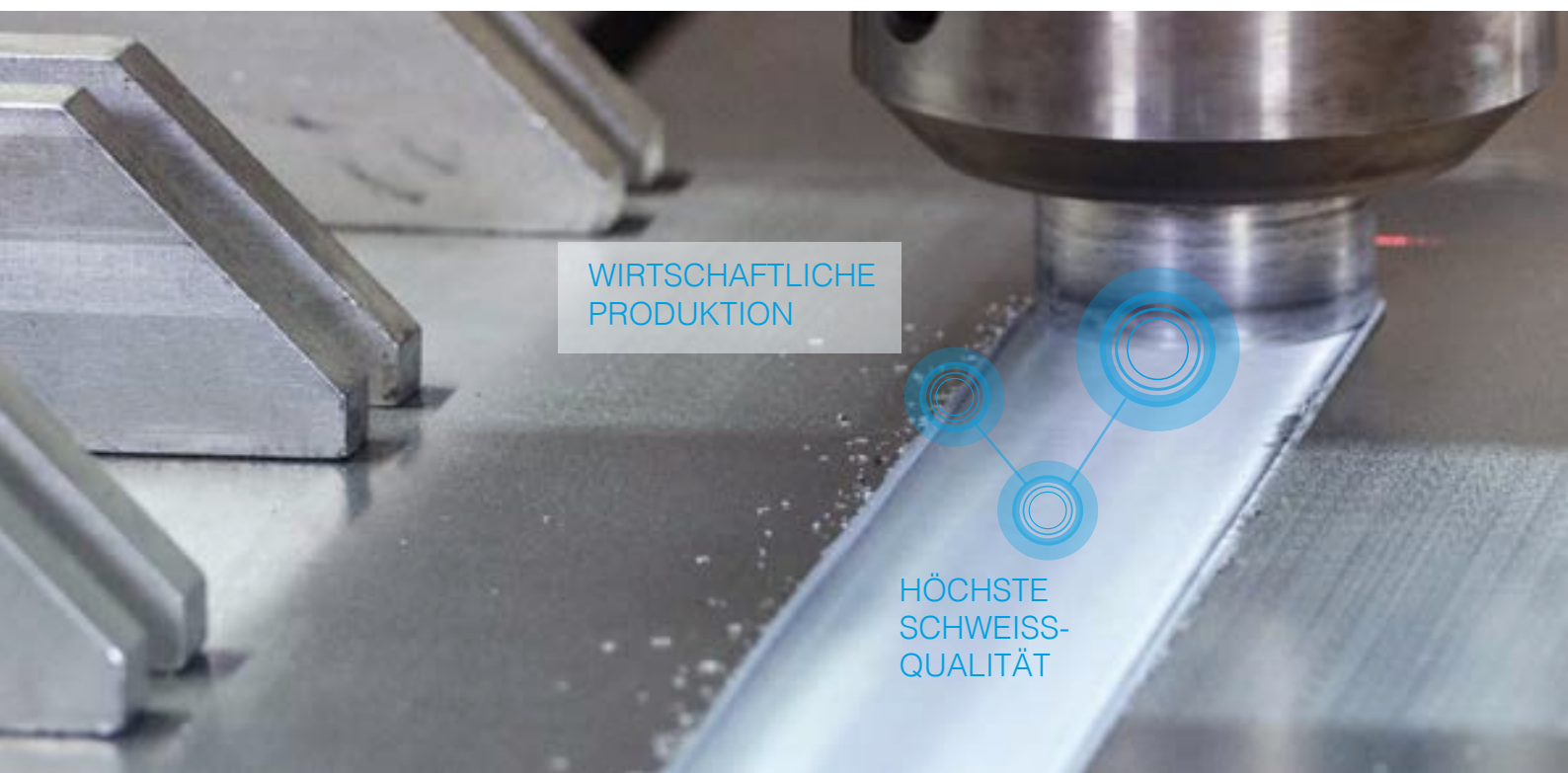
Unter stetigem Druck des rotierenden Werkzeugs werden die Werkstücke durch translatorische Bewegung miteinander verschweisst.
